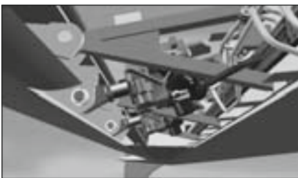
Abb. 9: Blick in die Querruderanlage des VR-Systems A320 (Bild: FRAUNHOFER IFF)
